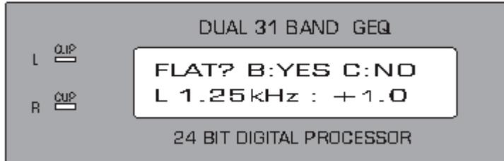
Bestätigen Sie den Vorgang mit der B-Taste oder brechen Sie ihn mit der C-Taste ab.
