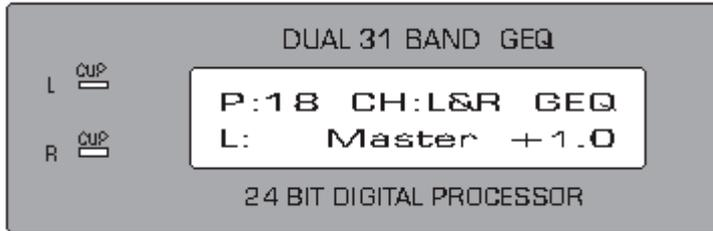
Drücken Sie die Frequenz-Taste und stellen Sie die gewünschte Frequenz (von 20 Hz – 20 kHz) über das Jog-Rad ein. Drücken Sie die Frequenz-Taste erneut und stellen Sie den Signalpegel über das Jog-Rad ein. Drücken Sie erneut die Frequenz-Taste um die Einstellung ab zu speichern.
