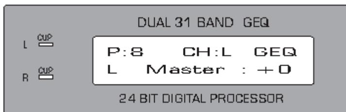
Sie sind nun wieder in das Hauptmenü zurückgekehrt und können durch Drücken der CH-SEL-Taste den gewünschten Kanal (Mono) „L“ oder „R“ einstellen. Für den „L & R“-Kanal (Stereo) halten Sie die Edit-Taste solange gedrückt, bis „L & R“ auf dem Display erscheint.
