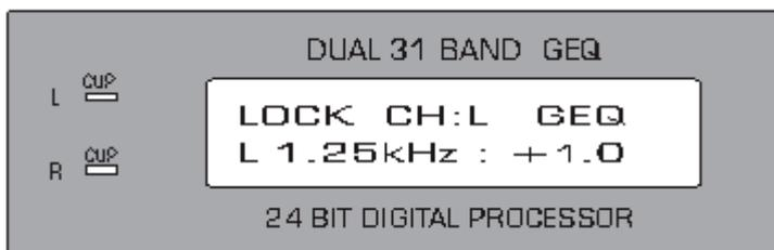
Halten Sie die Lock-Taste solange gedrückt, bis „LOCK“ auf dem Display erscheint. Alle Funktionen – inklusive Jog-Rad – sind nun gesperrt. Um diesen Vorgang wieder rückgängig zu machen, halten Sie die Lock-Taste solange gedrückt, bis „LOCK“ auf dem Display verschwindet.
