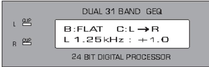
Drücken Sie die Edit-Taste (im Hauptmenü). Sie gelangen jetzt durch Drücken der Taste B in den Flat-Modus. Alle Frequenzen des gewählten Kanals werden damit auf 0 gesetzt.
