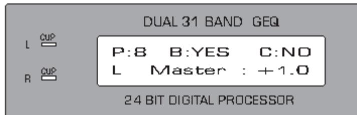
Durch Drehen des Jog-Rades können Sie nun das gewünschte Programm einstellen und den Vorgang entweder mit der Taste B bestätigen oder mit der Taste C (Edit-Taste) abbrechen.
