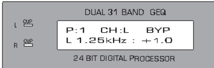
Drücken Sie die Bypass-Taste. Auf dem Display erscheint „BYP“ und der Equalizer wurde damit aus der Anlage "genommen". Durch erneutes Drücken der Taste wird auf dem Display „GEQ“ angezeigt; die eingestellten sind wieder Werte aktiv.
