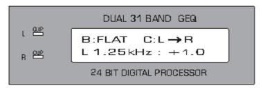
Drücken Sie die Edit-Taste (im Hauptmenü). Sie gelangen jetzt durch Drücken der Taste B in den Flat-Modus. Alle Frequenzen des gewählten Kanals werden damit auf 0 gesetzt.
