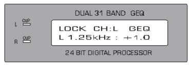
Halten Sie die Lock-Taste solange gedrückt, bis "LOCK" auf dem Display erscheint. Alle Funktionen – inklusive Jog-Rad – sind nun gesperrt. Um diesen Vorgang wieder rückgängig zu machen, halten Sie die Lock-Taste solange gedrückt, bis "LOCK" auf dem Display verschwindet.
