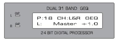
Drücken Sie die Frequenz-Taste und stellen Sie die gewünschte Frequenz (von 20 Hz – 20 kHz) über das Jog-Rad ein. Drücken Sie die Frequenz-Taste erneut und stellen Sie den Signalpegel über das Jog-Rad ein. Drücken Sie erneut die Frequenz-Taste um die Einstellung ab zu speichern.
