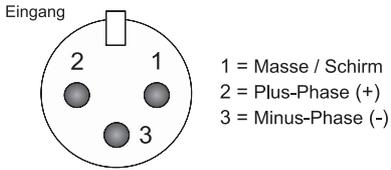
Um eine XLR-Verbindung unsymmetrisch anzuschließen, müssen Pin 1 und 3 gebrückt werden.
