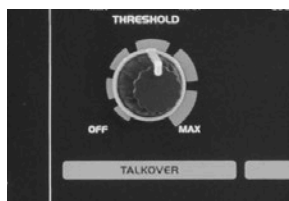
Einknopf-Kompressor und Auto-Talkover für jeden der Mikrofoneingänge
