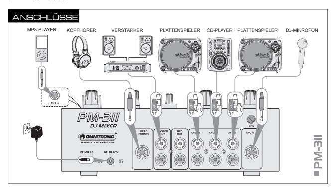
Schalten Sie das Mischpult und die anzuschließenden Geräte vor dem Anschluss bzw. vor dem Verändern von Anschlüssen aus.
