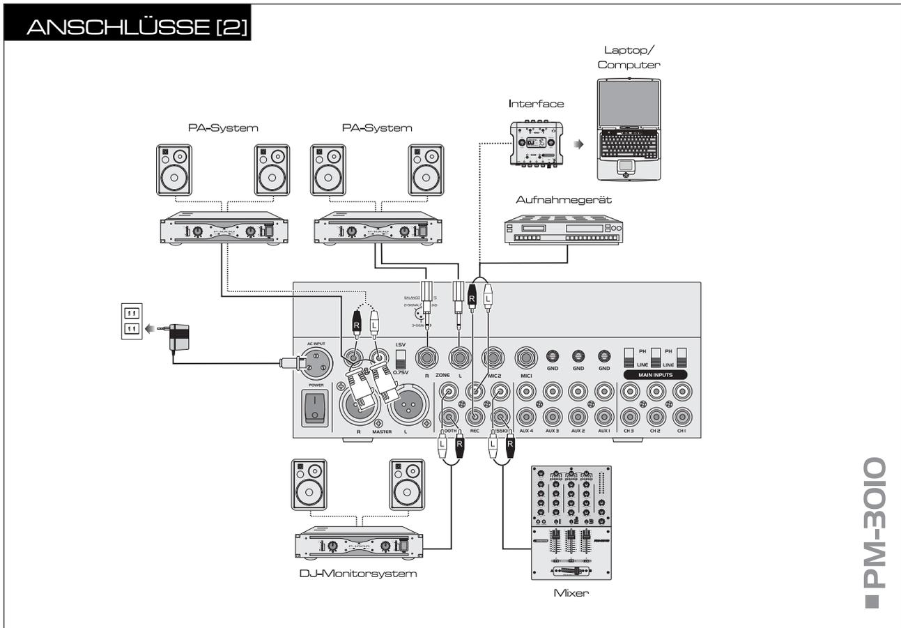
4. Zum Anschluss von Verstärkern stehen mehrere Stereo-Ausgänge mit eigenen Pegelreglern zur Verfügung:
