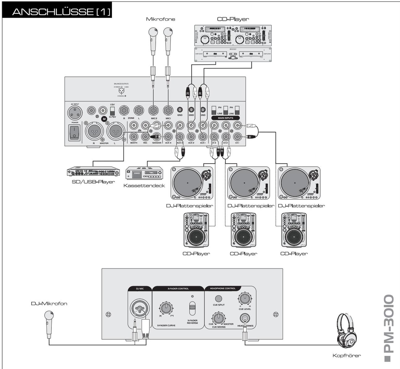
1. Schließen Sie Ihre Stereo-Signalquellen an die entsprechenden Cinch-Eingangsbuchsen an (weiße Buchse = linker Kanal, rote Buchse = rechter Kanal):
