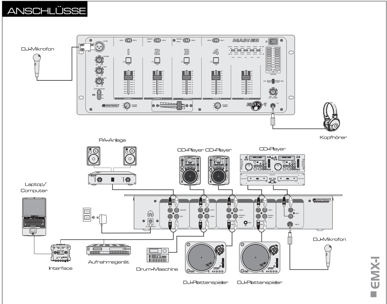
Schalten Sie das Mischpult vor dem Anschließen von Geräten aus.
