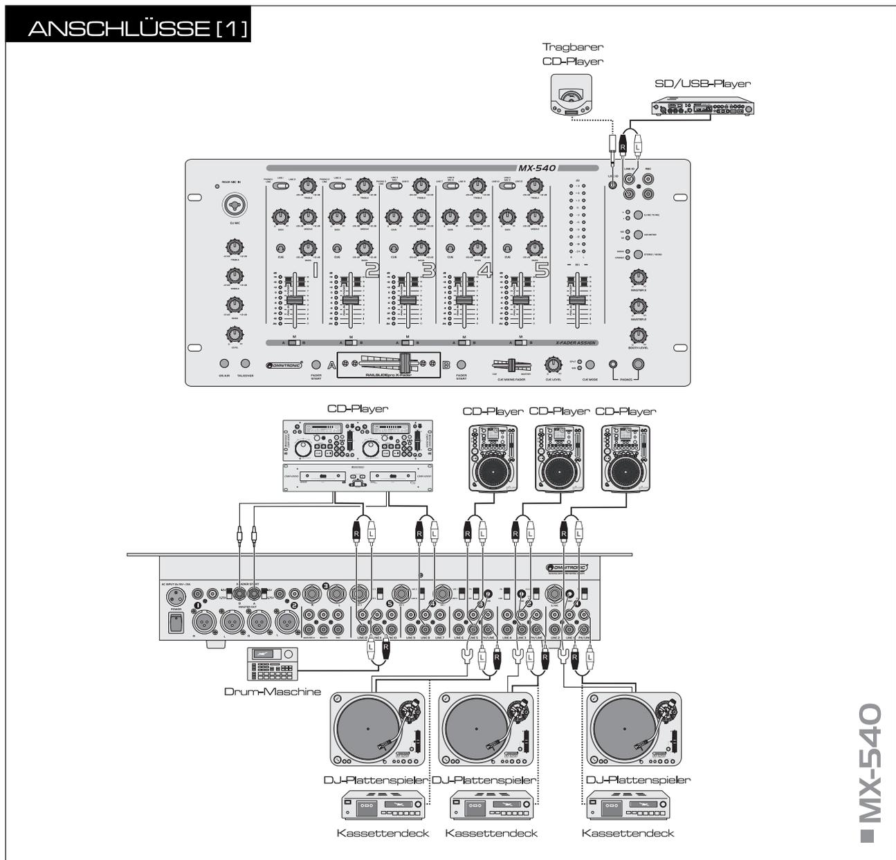
1. Schließen Sie die Stereo-Signalquellen an die entsprechenden Cinch-Eingangsbuchsen der Kanäle 1-5 an (weiße Buchse = linker Kanal, rote Buchse = rechter Kanal):
